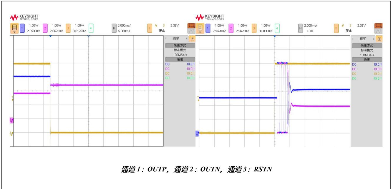
图 4. 复位拉低、拉高时输出波形曲线
