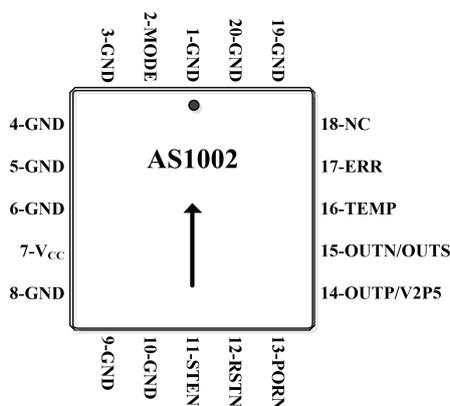
图 1. AS1000 引脚排布图 ( 顶视 )
