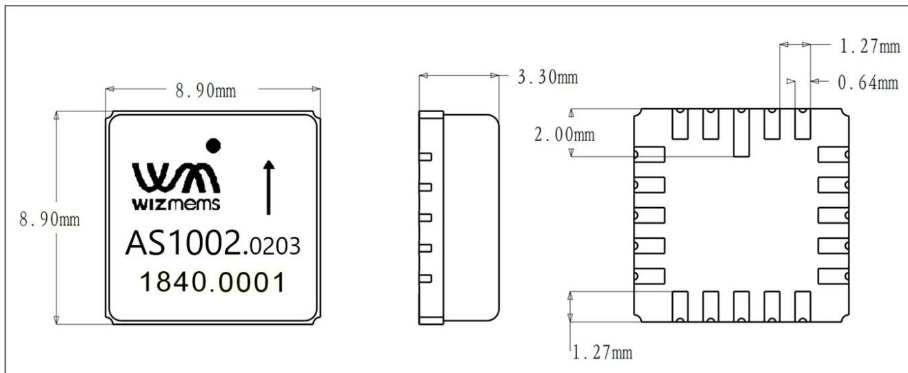
图6. AS1000 封装 (LCC20) 外形尺寸图
