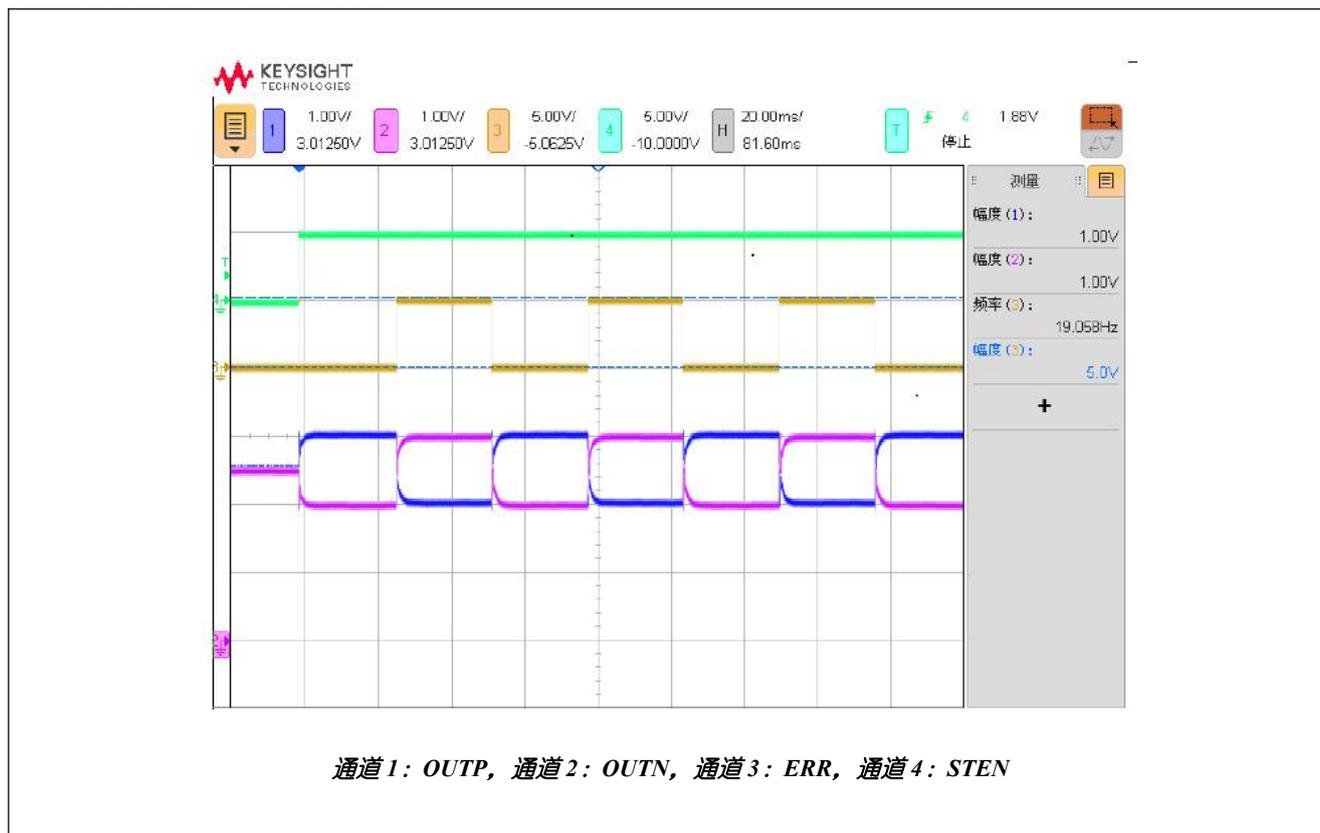
图 2. 自检测输出端口波形曲线
