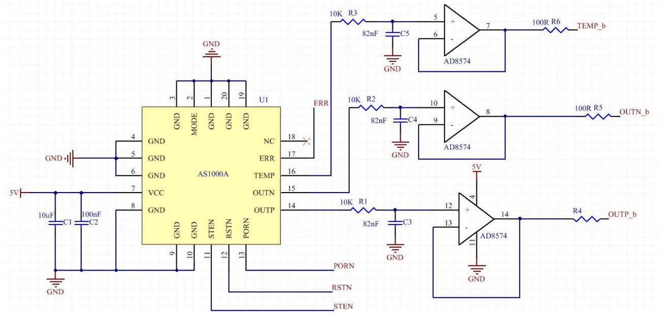
图 5. AS1000 加速度计推荐应用电路
